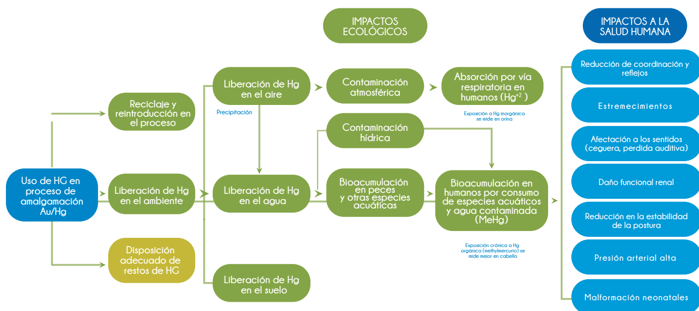
Figura 3: Uso de mercurio en el proceso de amalgamación
